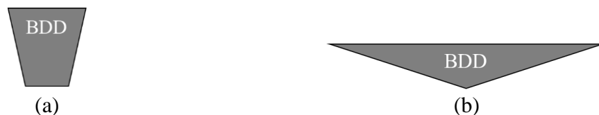
Figure IV.12 – Schéma des pointes de nanoindentation utilisées dans cette étude. (a) Poinçon plat de 5 \mu\text{m} de diamètre en BDD. (b) Pointe Berkovich en BDD.
