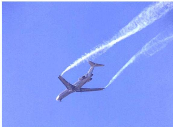
**Figure (I-5) :** Photo d'un Boeing 727 en vol d'étude. Un fumigène placé à l'extrémité des ailes permet de visualiser le tourbillon formé. Source NASA.
