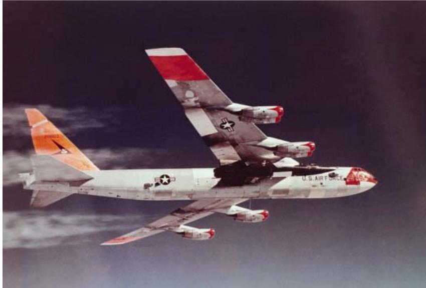
**Figure (5-3) :** Photographie d'un avion porteur de type Boeing B-52, portant un North American X-15. La traînée de condensation se forme progressivement, quelques mètres derrière le réacteur. Source NASA.
