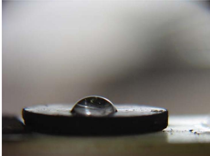
**Figure (1-14) :** Photographie d'une gouttelette d'eau en contact avec une surface de suie (Popovitcheva). La surface est partiellement mouillée.
