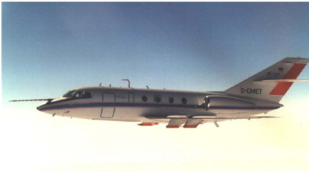
**Figure (4-29) :** Avion de recherche de type Dassault Falcon du DLR (Photographie Petzold et al., 1997).
