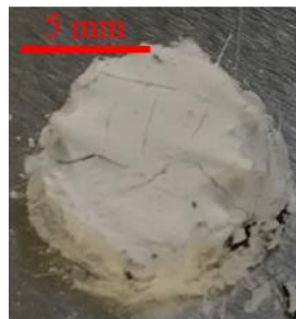
Figure II.4 : Composite cru imprégné par immersion manuelle puis séché à l'étuve
