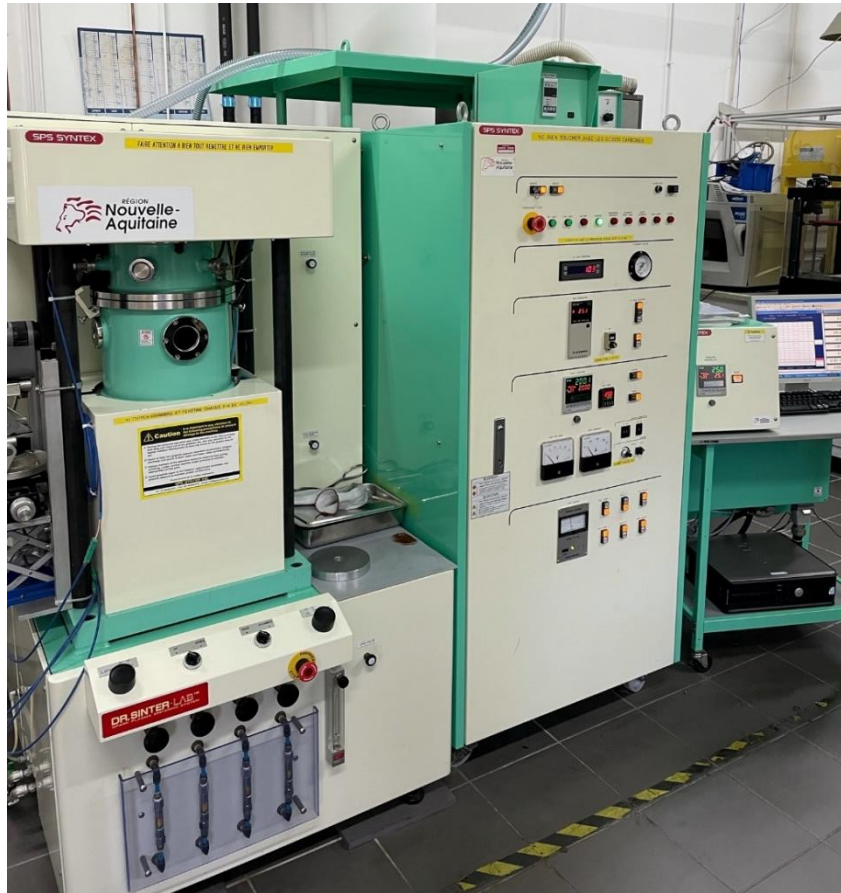
Figure II.5 : Installation de SPS à l'ICMCB
