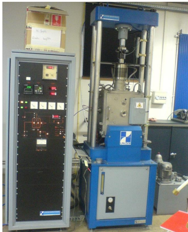
Figure II.9 : Photographie du four HP de l'IRCER
