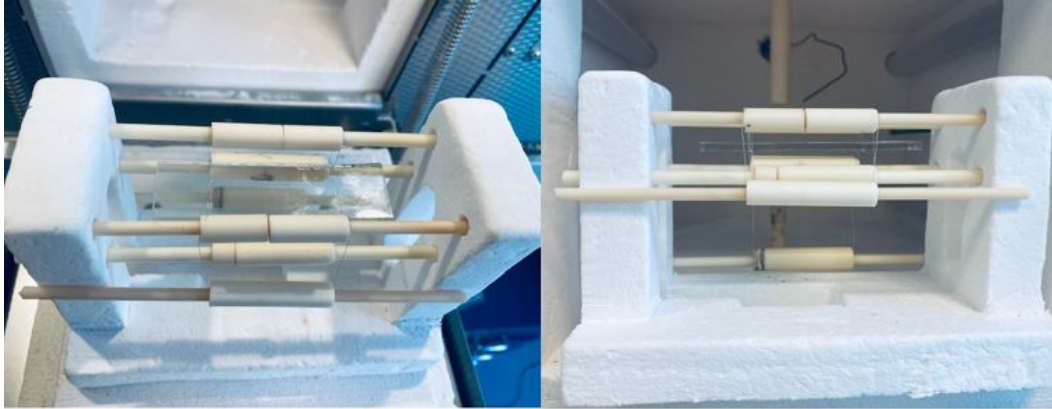
FIGURE 4.4 – Les deux vues de la configuration expérimentale des verres sodocalciques pour les mesures par la technique d'excitation par impulsion
