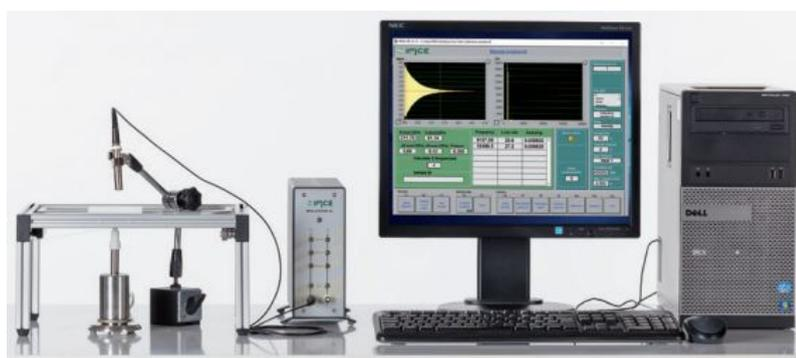
FIGURE 2.7 – Équipement TEI pour des mesures à température ambiante
