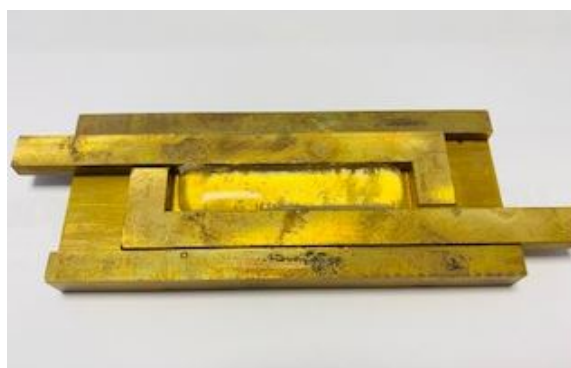
FIGURE 2.6 – verre fondu refroidi au sein du moule
