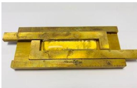
FIGURE 2.6 – verre fondu refroidi au sein du moule
