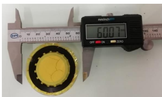
Figure II-2 - Porte-échantillon pour les analyses en DRX avec la poudre protégée d'un film Kapton® de 7.5 µm d'épaisseur
