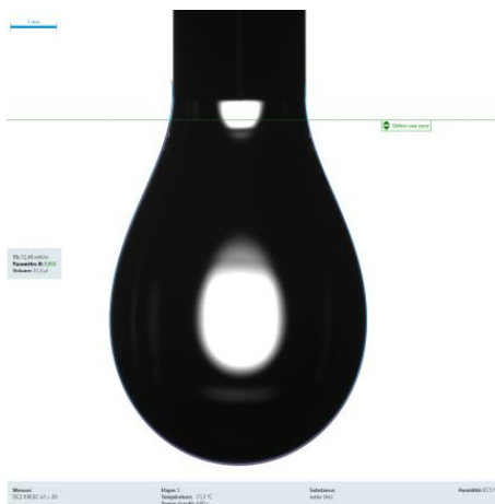
Figure II-15 - Goutte pendante d'une solution aqueuse de DC2.
