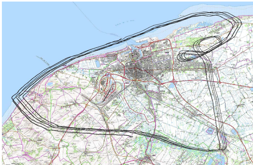
FIGURE 12: Traces d'empreintes satellitaires d'angles d'élévation élevés le long de la trajectoire de vol (fond de carte IGN).
