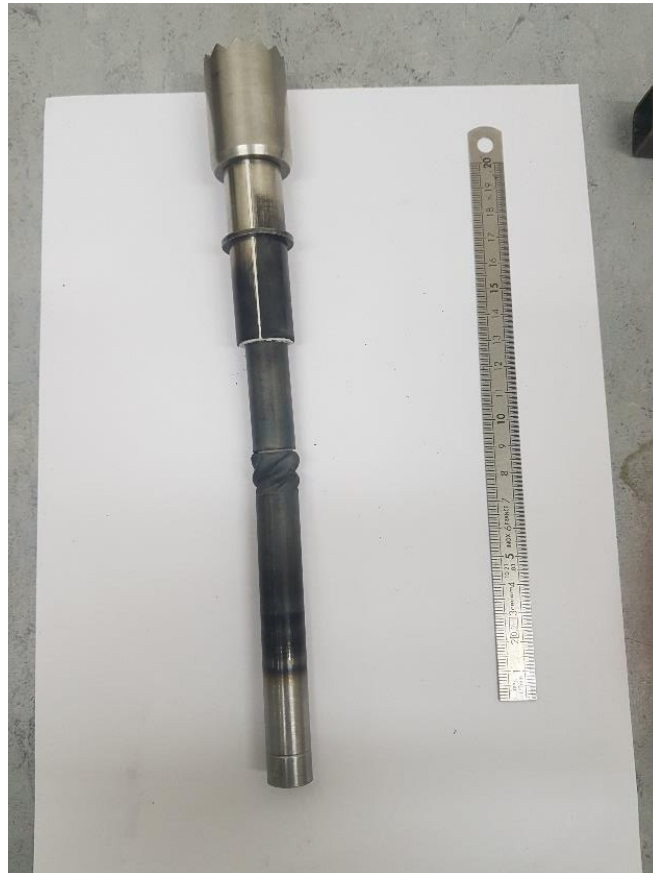
Figure 27 : Colonne-échantillon Pp7 après déformation en torsion à la Presse Paterson
