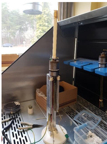
Figure 23 : Montage de la capsule sur un obturateur permettant son introduction dans le Four Khantal avant insertion dans l'autoclave
