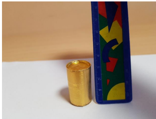
Figure 22 : Capsule d'Or utilisée pour la pré-hydratation d'HPG8
