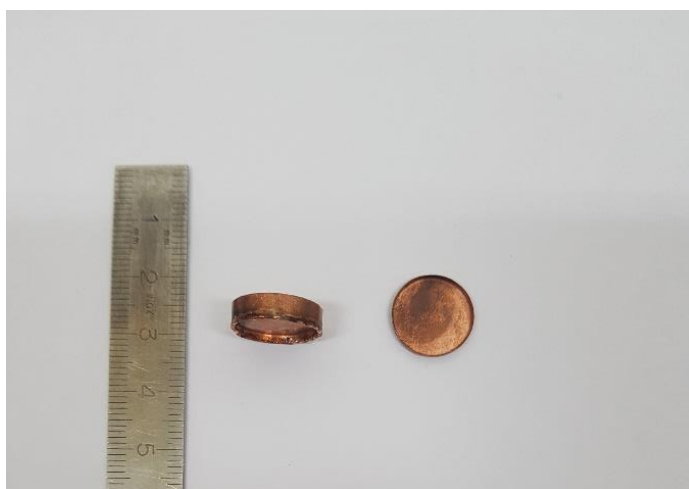
Figure 24 : Fond de la capsule en cuivre et son couvercle qui seront soudés après introduction de l'échantillon.
