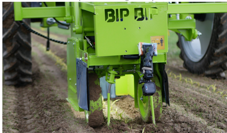
Figure 1.23 – Module de désherbage BIP-BIP
