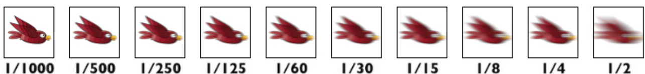
Figure 2.7 – Effet du temps d'intégration (en seconde) sur le flou de bougé
