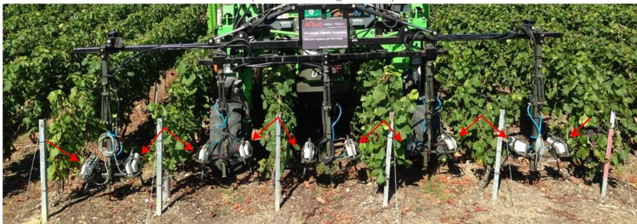
Figure 1.20 – Présentation du WeedSeeker en viticulture
