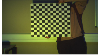
Figure 3.10 – Échiquier de calibration géométrique
