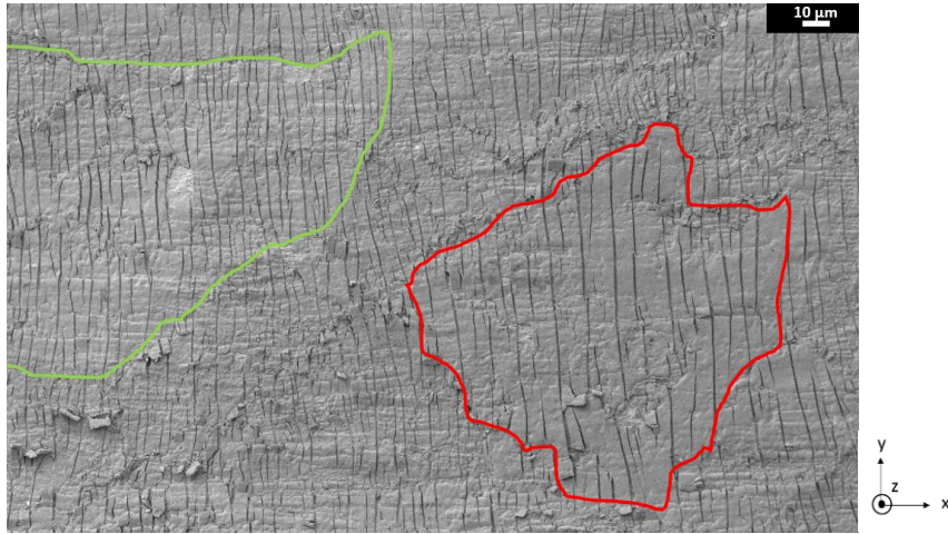
Figure 45 : Cliché MEB de la surface de l'éprouvette Ni/NiO_1_4 pour une déformation de 28%
