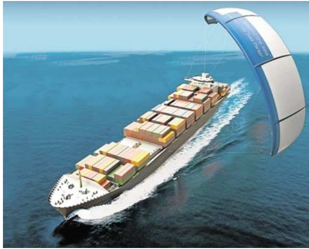
FIGURE 1.1– Principe de traction de navires par kite géant - Projet BTS - ( www.beyond-the-sea.com )
