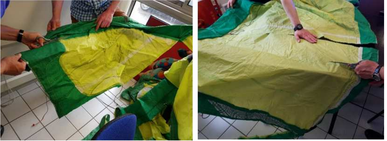
FIGURE 3.2 – Prélèvement d'échantillons sur un kite usagé
