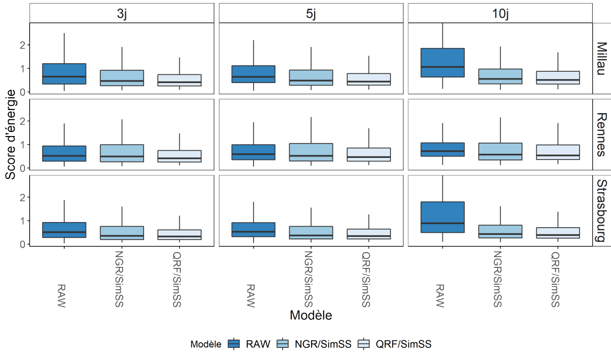
FIGURE 1.4 – Boîtes à moustaches des ES estimés par modèle, localisation spatiale et échéance de prévision. Les stations sont représentées par lignes, échéances par colonnes et modèles par couleurs. RAW : ensembles du modèle de prévisions numériques ; NGR : ensembles du modèle de régression non homogène ; QRF : ensembles du modèle de forêt aléatoire.
