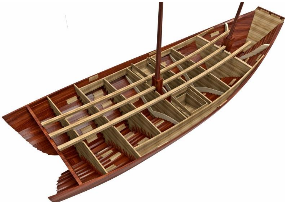
Figure 20 : Reconstitution 3D de la structure interne du navire de Sin'an (crédit : CENTRE NATIONAL DE RECHERCHES SUR LE PATRIMOINE MARITIME)
