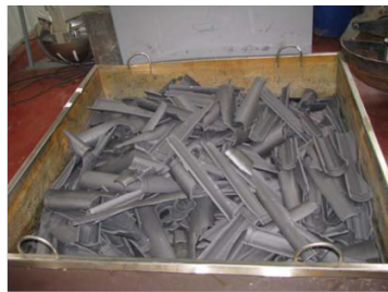
(a) Graphite après dégainage
