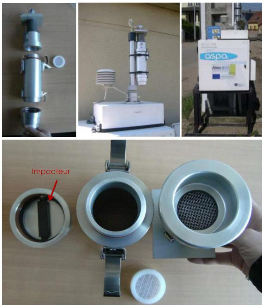
Figure 2.1 : Exemple de préleveur Partisol Plus<sup>®</sup> sur support (en haut à droite). Raccord préleveur/cartouche (en haut au milieu). Cartouche Chemcomb<sup>®</sup> (en haut à gauche) et Intérieur de la cartouche (en bas) (Bertrand et Pierre, 2015)
