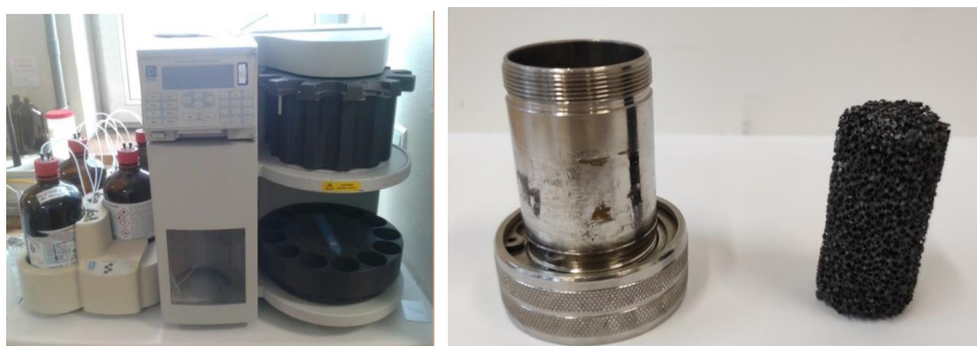
Figure 3.7 : DIONEX® ASE 300 (gauche) et cellule d'extraction de 34 ml et mousse correspondante (droite)
