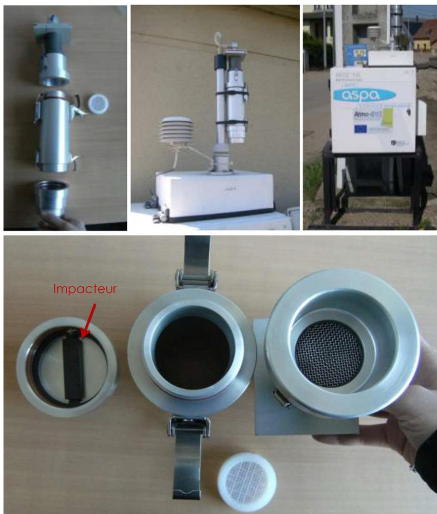
Figure 2.1 : Exemple de préleveur Partisol Plus ® sur support (en haut à droite). Raccord préleveur/cartouche (en haut au milieu). Cartouche Chemcomb ® (en haut à gauche) et Intérieur de la cartouche (en bas) (Bertrand et Pierre, 2015)
