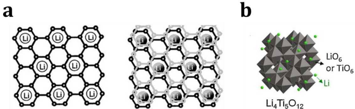
Figure 7. (a) Illustration de l'intercalation du lithium entre deux feuilles de graphène 24 . (b) Structure cristalline du titanate de lithium 27 .
