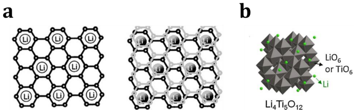
Figure 7. (a) Illustration de l'intercalation du lithium entre deux feuilles de graphène 24 . (b) Structure cristalline du titanate de lithium 27 .
