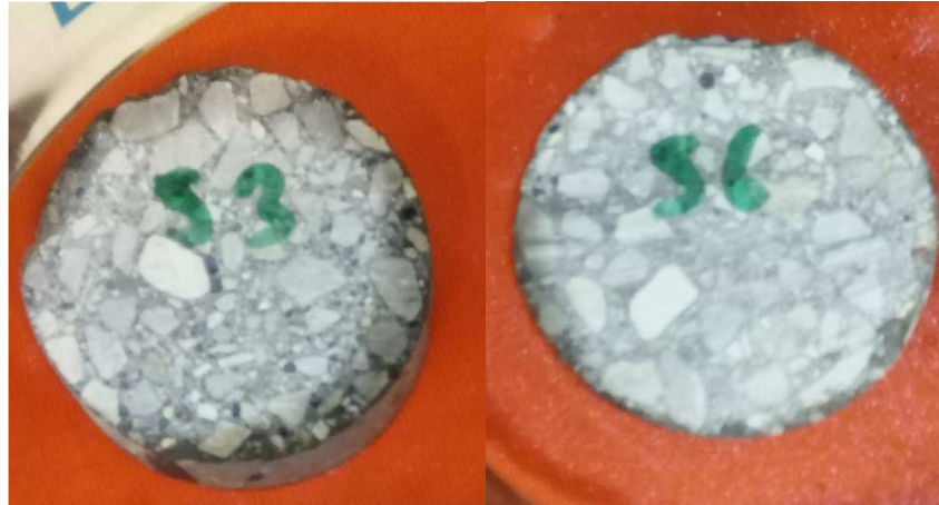
Figure IV - 2 : Photographies prises au même instant de la frange capillaire atteignant la face supérieure pour l'échantillon S3 (à gauche) et début d'apparition de frange capillaire pour l'échantillon S6 (à droite).
