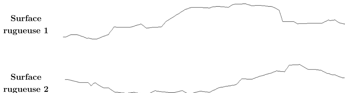
Figure VII - 10 : Création de deux surfaces rugueuses aléatoires avec le modèle utilisé.
