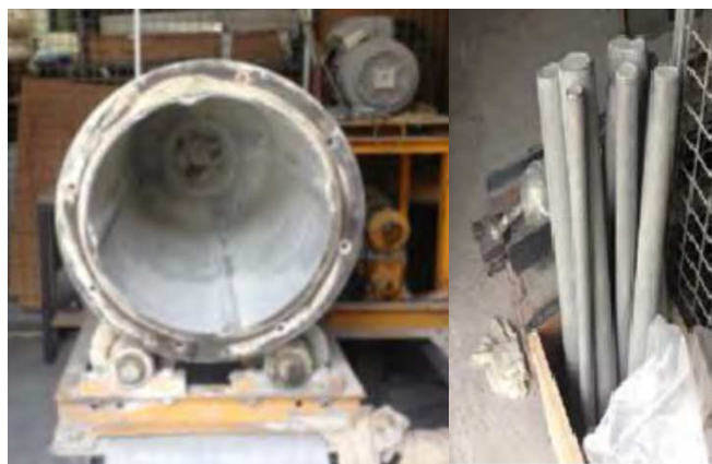
Figure II - 4 : Broyeur et ses barres d'après (Leung Pah Hang 2015).
