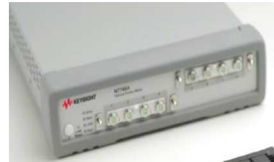
Powermeter (4 entrées) Keysight N7745a
