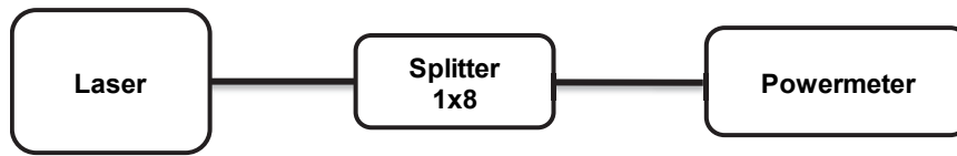
Figure II.12 : Schéma fonctionnel du montage laser + séparateur + puissance-mètre
