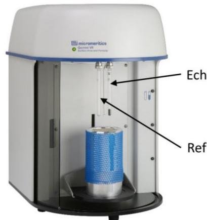
FIGURE 2.5 – Appareil de mesure de surface spécifique.
