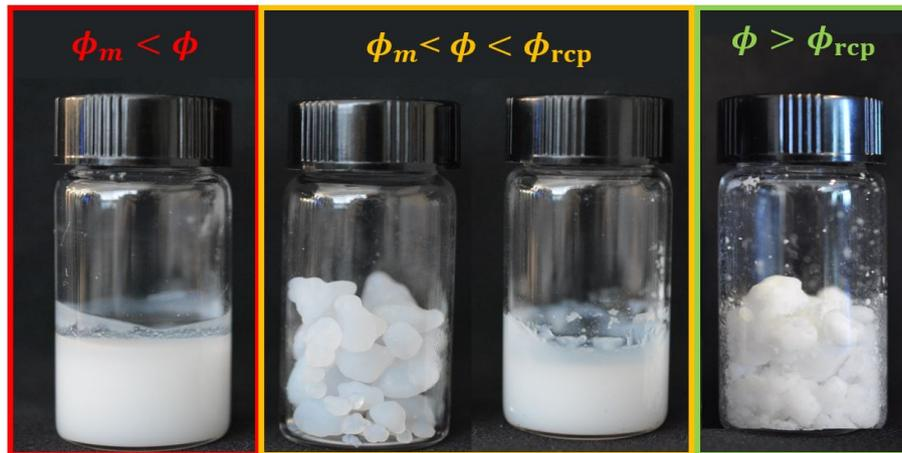
FIGURE 2.27 – Formulation de suspensions concentrées de silice à différentes fractions massiques.
