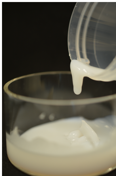
FIGURE 2.13 – Photographie d'une suspension de silice à \phi^{\text{wt}}=0.24 présentant un seuil d'écoulement.
