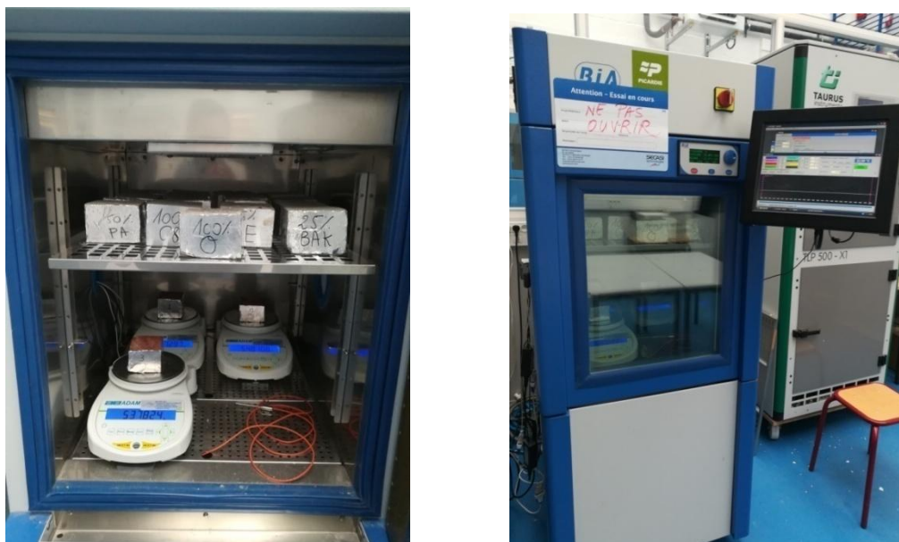
Figure VII-19 : Enceinte climatique pour essai MBV.
