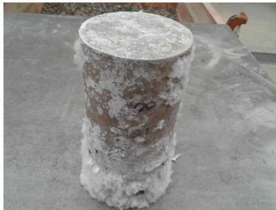
Figure V-6 : Salpêtre sur une éprouvette de béton.
