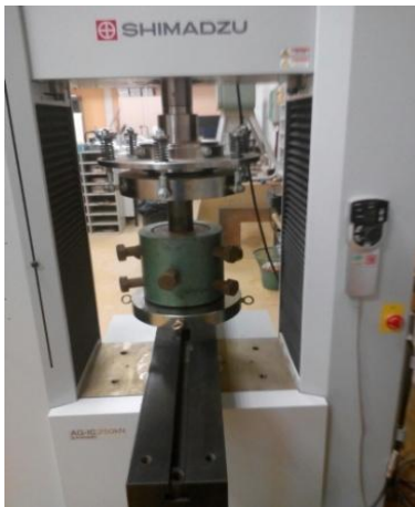
Figure III-23 : Essai d'écrasement en vrac des granulats.
