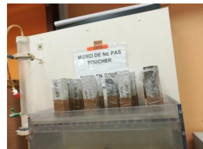
Figure VII-1 : Dispositif de détermination du coefficient d'absorption d'eau par capillarité.
