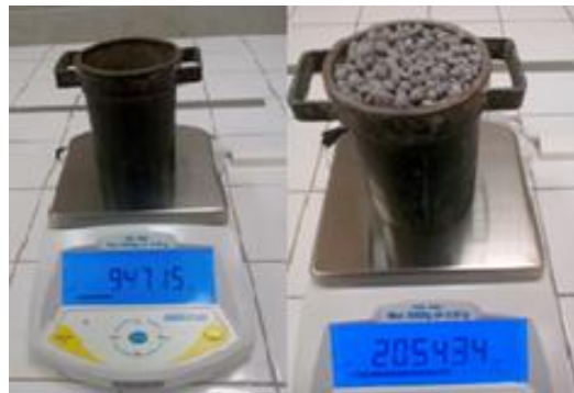
Figure III-11 : Mesure de la masse volumique apparente.
