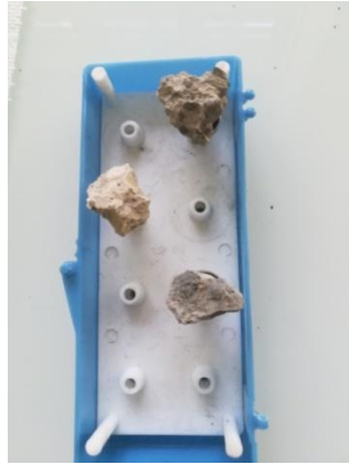
Figure V-18 : Préparation des échantillons pour visualisation au MEB.
