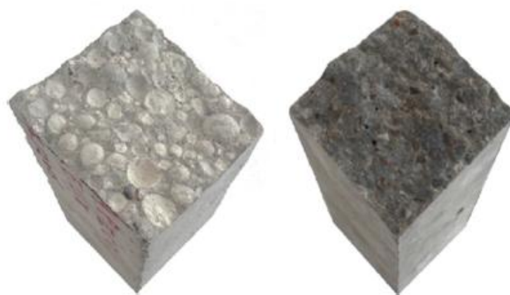
Figure V-13 : Faciès de rupture des éprouvettes en traction indirecte par flexion.
