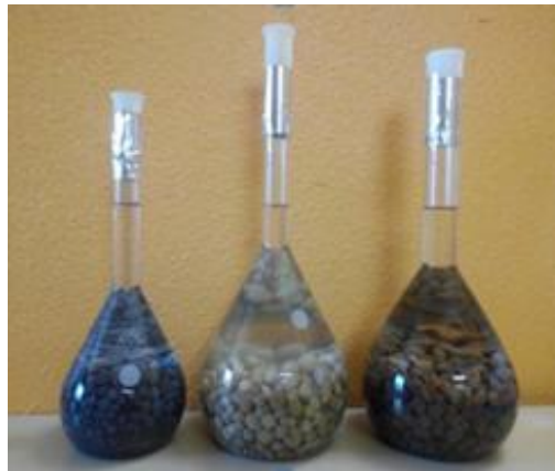
Figure III-16 : Mesure de la porosité des granulats.
