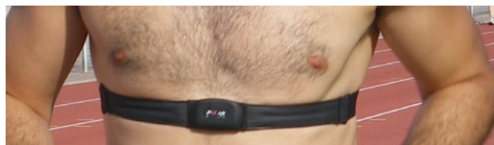
FIGURE 2.6 – Ceinture Polar® permettant l'enregistrement de la fréquence cardiaque en continue.
