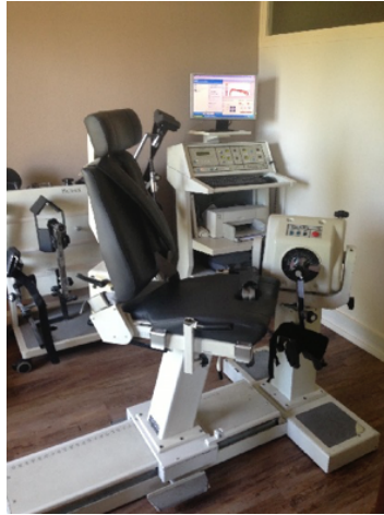
FIGURE 2.3 – Illustration de l'appareil Biodex®.
