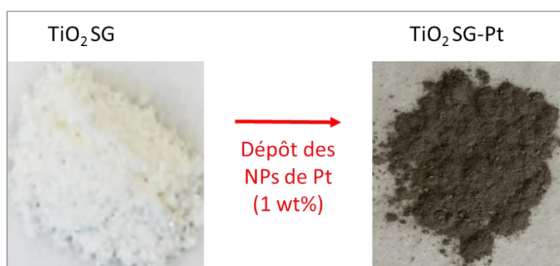
Figure II.13: Evolution visuelle de la couleur d'un échantillon de \text{TiO}_2 SG avant et après dépôt de 1% massique de NPs de Pt.
