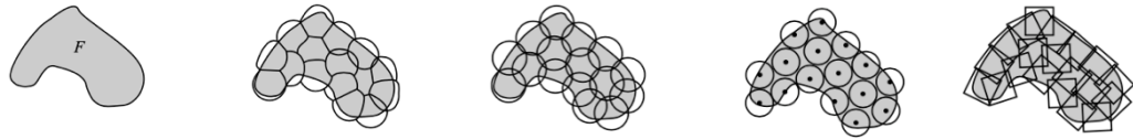
Figure 2. 1 Exemple d'une mise à l'échelle d'un système par recouvrement de ce dernier avec des formes géométriques de faible diamètre ou de faible longueur (cercle, carré) pour déterminer sa dimension avec la méthode de Hausdorff. ( google.com/images.com )
