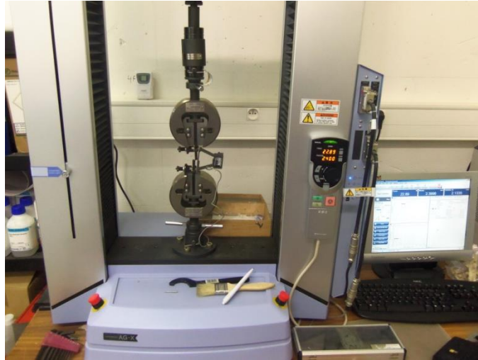
Figure 14 . Dispositif expérimental de l'essai de traction
