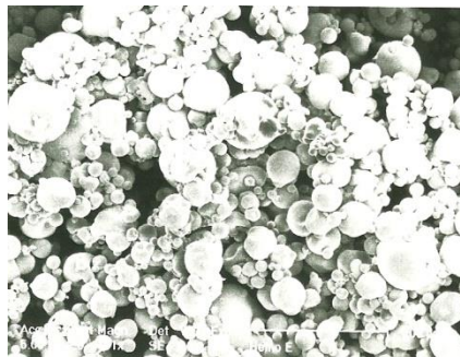
Figure 21. Image MEB d'un échantillon de poudre d'hémoglobine (Grossissement X151)
