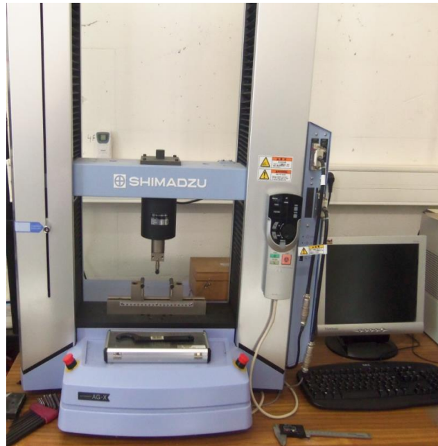
Figure 15. Dispositif pour l'essai de flexion
