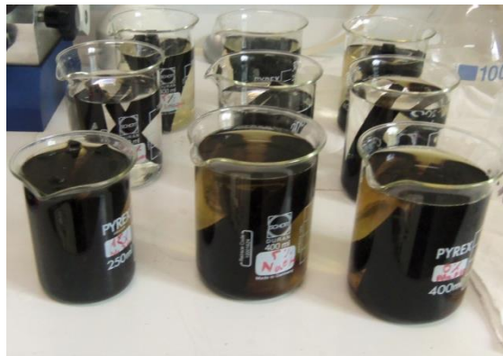
Figure 19. Immersion des éprouvettes de traction et de flexion dans différents solvants
