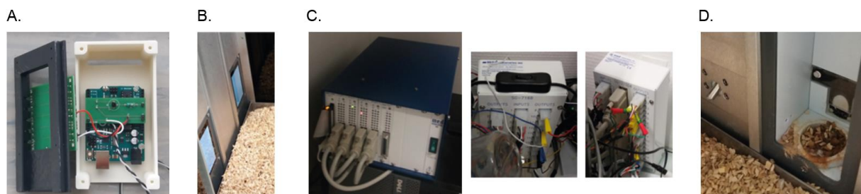
Figure 2 : Difficultés rencontrées avec le système commercial adapté. A. Boîtier développé pour passer d'une réponse tactile à une détection par des faisceaux infrarouges. L'adaptation a requis l'usage d'un Arduino, de deux circuits imprimés et deux pièces 3D créées spécifiquement pour cet usage. B. La conception de la cage avec l'emploi de rails limite la variété de disposition et de choix du matériel. C. Le dispositif est particulièrement encombrant et délicat au niveau des connexions. D. Les chambres ne sont pas adaptées à la vie en continu des animaux : ici l'exemple d'une souris urinant en permanence dans la mangeoire.
