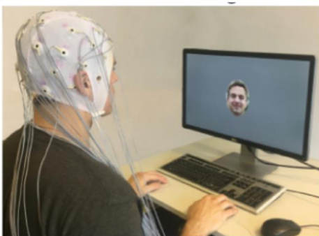
Figure 1 : Protocoles expérimentaux d'enregistrement de l'activité cérébrale lors de la réalisation d'une tâche comportementale. A. Enregistrement électroencéphalographique chez un sujet humain réalisant une tâche sur un ordinateur (Davis et al., 2020). B. Enregistrement de l'activité de neurones par imagerie calcique chez une souris libre de ses mouvements, réalisant une tâche dans une chambre opérante équipée d'écrans tactiles (Mosser et al., 2020).
