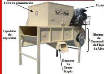
Venteadora V-M instalada y lista para iniciar su trabajo de limpieza de granos de quinua
