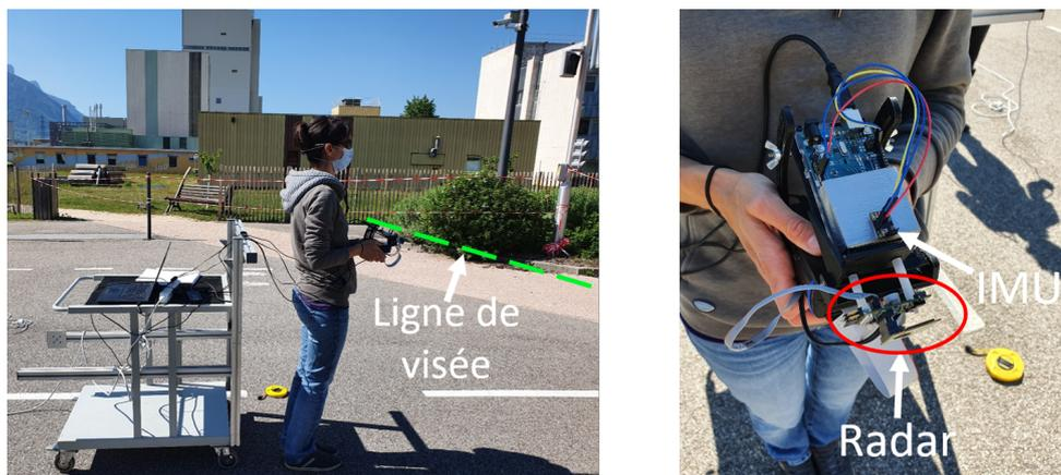
FIGURE 3.25 – Dispositif expérimental radar+IMU
