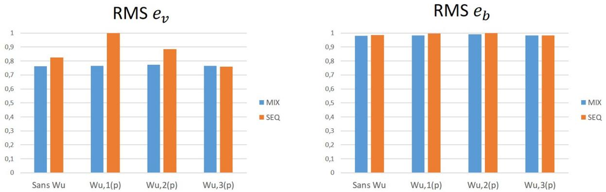
FIGURE 4.22 – Valeurs RMS des erreurs d’estimation de la vitesse et du biais en fonction de  $W_u(p)$
