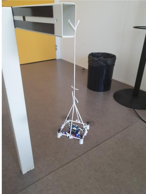
FIGURE 3.5 – Enregistrement des mesures IMU lorsque le drone est en vol stationnaire
