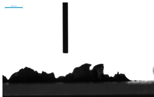
Figure V-12 – Ecaillage du film argileux sur lame de verre après dépôt d'une goutte d'eau – concentration en montmorillonite = 5g/100 mL.
