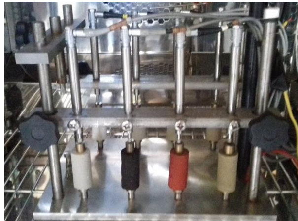
Figure II-7 - Banc dilatométrique en enceinte climatique avec des éprouvettes d'argile/sable/molécules organiques.
