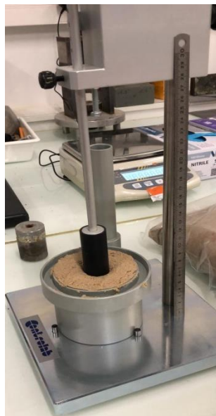
Fig. Annexes 37 – Essai de consistance au plongeur de pénétration
