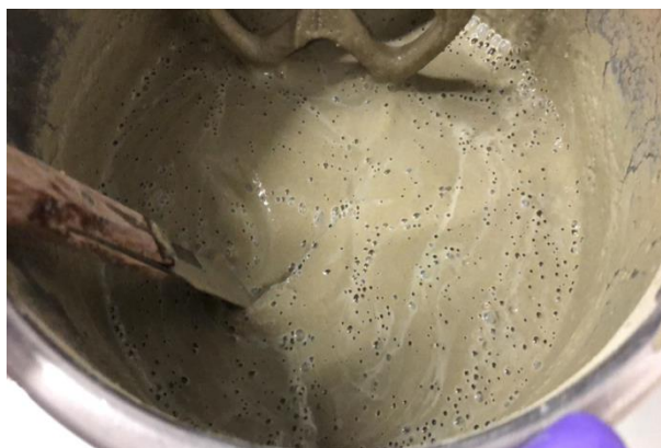
Fig. Annexes 44 – Formulation argile verte/sable/solution de DC8 1wt% par rapport à la masse d'argile verte.
