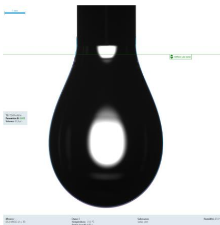
Figure II-15 - Goutte pendante d'une solution aqueuse de DC2.
