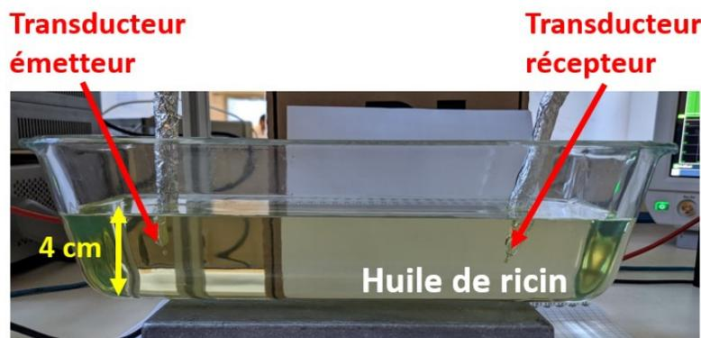
Figure 6.6. Atténuation en fonction de la distance pour une fréquence de 1,000077 MHz dans l'huile de ricin
