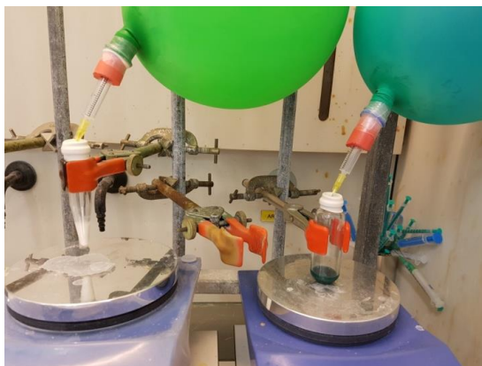
Figure 27 : A gauche, la suspension du sel dans le THF. A droite, la solution du catalyseur et la base dans le THF.
