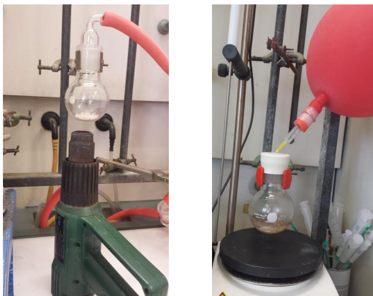
Figure 54 : Activation du tamis moléculaires et séchage du 1,2-dichloroéthane.
