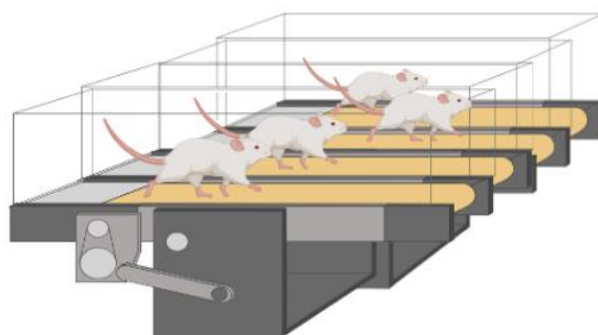
Figure 76 : Tapis de course pour rongeur en configuration rat. 4 couloirs distincts en plexiglas permettent à 4 individus de courir en parallèle.
