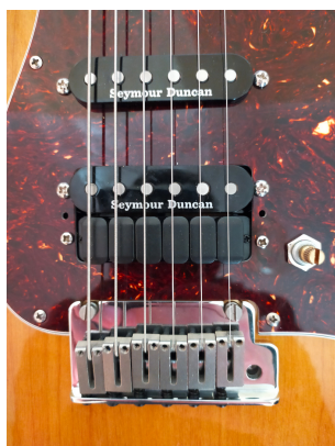
(c) Cycfi Nu installé sur une guitare de type Fender Stratocaster.
