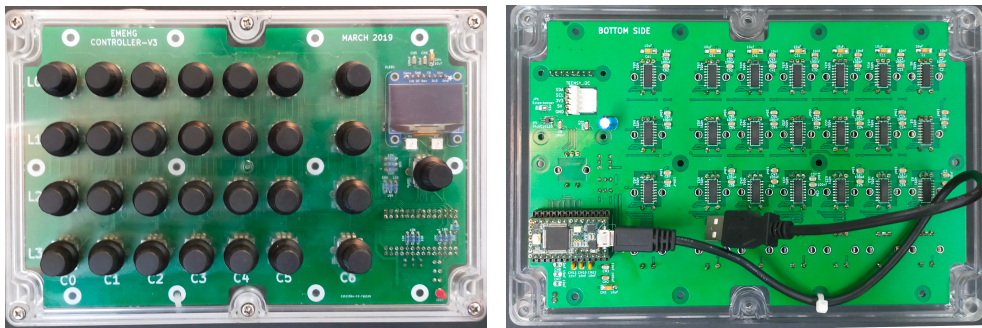
FIGURE 3.19. Contrôleur de paramétrage des traitements en version externe. À gauche, la face avant du contrôleur, à droite, la face interne de la carte électronique sur laquelle on distingue la Teesny 3.2 et les 7 groupes de 3 multiplexeurs. Le câble USB est relié à un connecteur fixé au boîtier.
