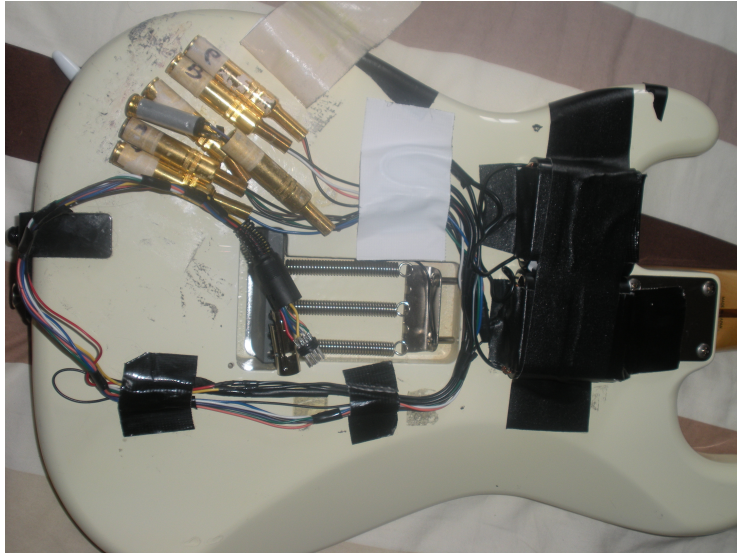
FIGURE 3.10. Version primitive d'un système de conversion et d'alimentation du microphone hexaphonique. À droite, sous le papier collant noir, les deux piles 4.5V, en haut à gauche les 6 connecteurs Jack 6.35mm femelles et au milieu le connecteur DIN 13 broches.
