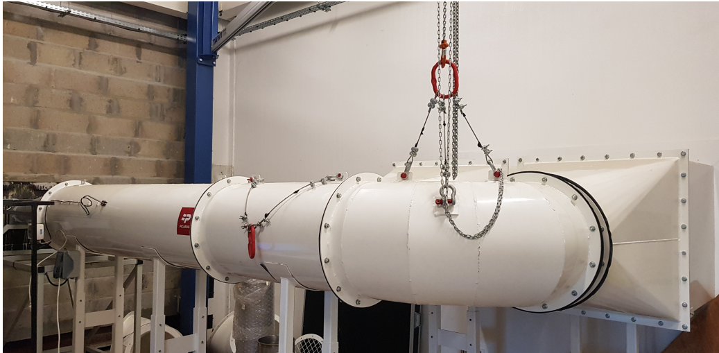
Fig. 3.5 Conduit extérieur en sortie de soufflerie.
