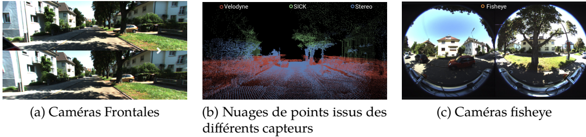
FIGURE 2.18 – Exemple de données capteur présentes dans la base KITTI-360 (LIAO, XIE et GEIGER, 2021)
