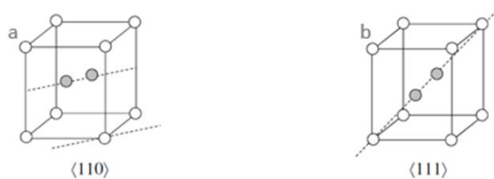
Figure 5 : Schémas des dumbbells de direction \langle 110 \rangle dans le fer- \alpha (a) et \langle 111 \rangle (b) dans les autres métaux de transition.
