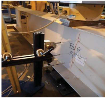
Figure II-10 : Disposition des capteurs horizontaux sur panneau d'âme
