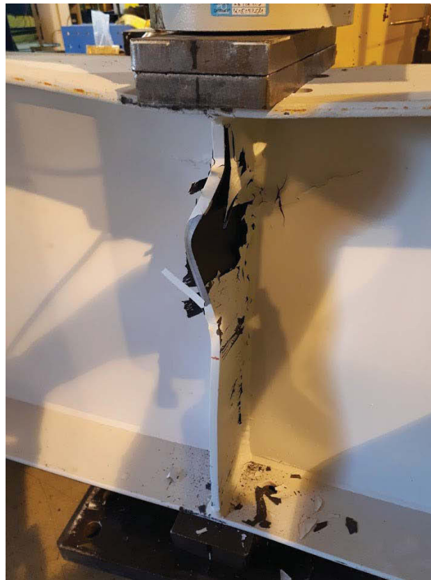
Figure II-17 : Observation de la déformée à la ruine d'un profilé raidi (configuration Sp)
