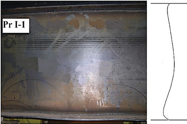
Figure I-29 : Mode de ruine d'un profilé avec un élancement d'âme égal à 160
