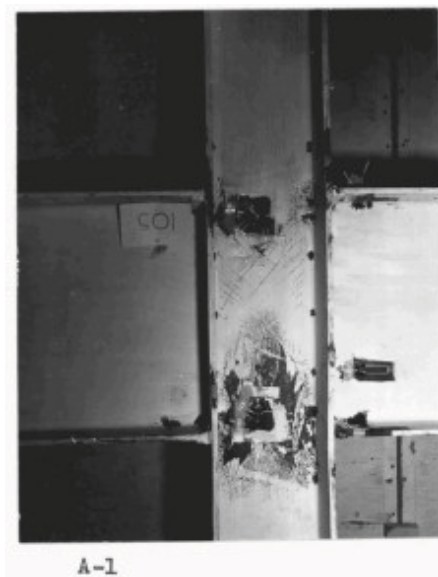
Figure I-38 : Assemblage non raidi testé par (Graham et al. 1959)
