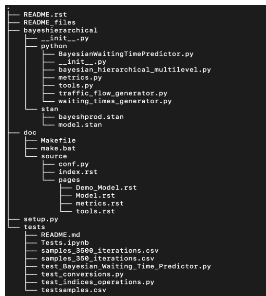
Figure 6.2 – La structure du paquet bayesian-hierarchical-model , vue sous forme d'arborescence affichant les dossiers et fichiers présent du paquet.
