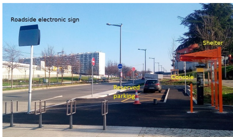
Figure 1.3 – Configuration d’un arrêt de covoiturage connecté. La structure orange ressemble à un abribus. Le passager informe les conducteurs potentiels de sa demande de covoiturage à l’aide de la console, demande qui est ensuite affichée sur le panneau électronique lumineux au bord de la voirie. Un conducteur peut récupérer le passager en toute sécurité sur la place de stationnement réservée à cette occasion. Photographie reproduite avec l’autorisation d’Ecov.
