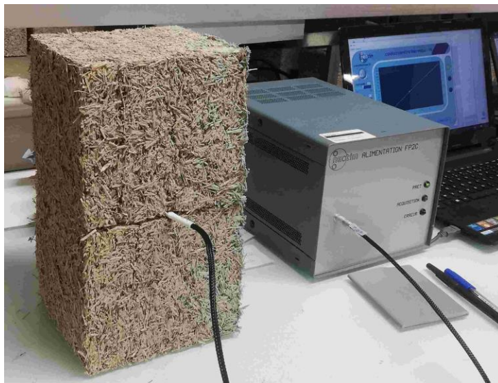
Figure 3.4. Mesure de la conductivité thermique entre deux échantillons de 15 \times 15 \times 15 \text{ cm}^3 .
