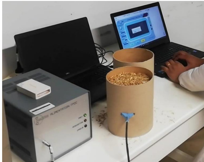
Figure 2.28. Mesure de conductivité d'un échantillon de granulat végétal.
