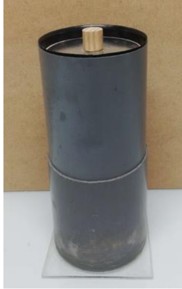
Figure 2.13. Récipient cylindrique de 12,0 cm de diamètre et de 28,3 cm de hauteur utilisé pour déterminer la masse volumique en vrac des granulats végétaux.
