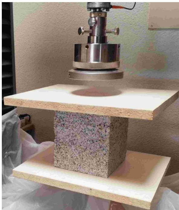
Figure 3.11. Mise en place de l'éprouvette de béton végétal entre les plateaux de la presse et les contreplaqués avant l'essai de compression cyclique.
