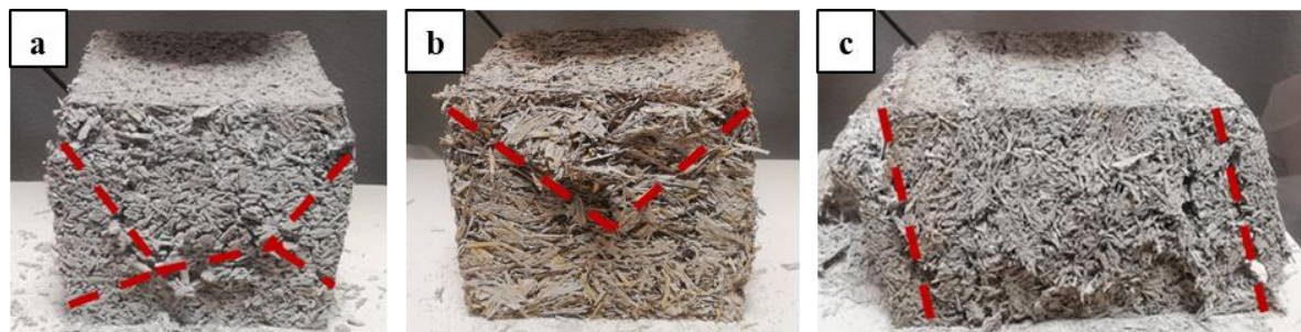
Figure 3.13. Faciès de fissuration en compression dans la direction parallèle des blocs de bétons formés avec des granulats (a) de type écorce et (b) paille, et faciès de fissuration dans la direction (c) perpendiculaire (cas du béton d'anas de lin CF-AL-M1).
