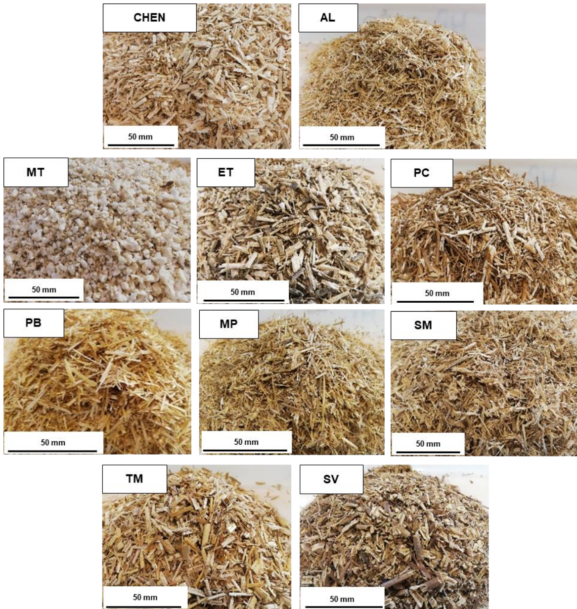
Figure 2.2. Illustration des aspects visuels des granulats végétaux retenus (CHEN : chènevotte, AL : anas de lin oléagineux, MT, moelle de tournesol, ET : écorce de tournesol, PC : paille de coriandre, PB : paille de blé, MP : menues pailles de blé, SM : spathes de maïs, TM : tige de miscanthus, SV : sarments de vigne).
