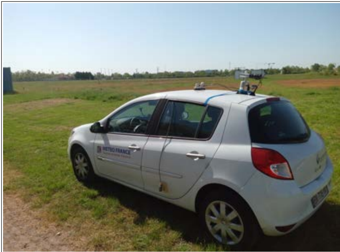
Figure 21, la Renault Clio II instrumentée. La sonde de température est sur le toit, sur sa portière arrière gauche est visible le capteur de température de surface.
