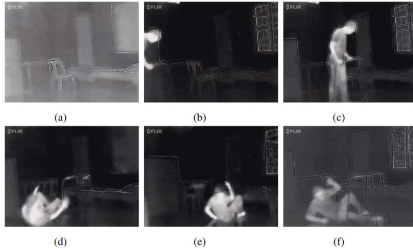
FIGURE 2.16 – Exemple d’images fournies par le capteur thermique Flir One (a : scène vide , b : la personne entre dans la scène, c : exemple d’ADL et d,e,f : exemples des chutes) [58].
