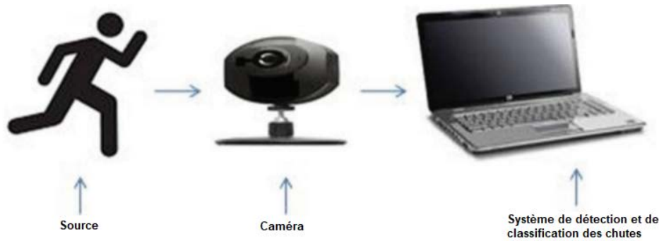
FIGURE 1.7 – Système de détection des chutes basé sur la vision [9].
