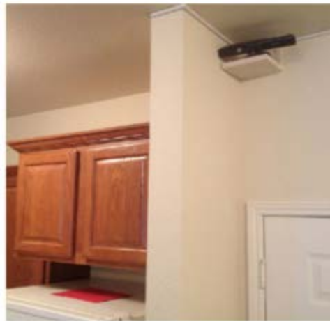
FIGURE 2.13 – Installation du dispositif de détection de la chute dans l'appartement d'une personne âgée [54].
