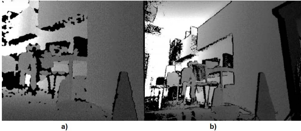
FIGURE 2.2 – Exemple d’images obtenues avec a) une Kinect V1 et b) une Kinect V2 [52]
